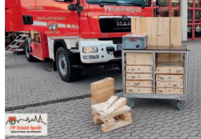
müssen auch gesichert werden. Auf den Löschfahrzeugen steht nicht genügend Platz für ausreichend Material zum Unterbauen zur Verfügung. Deshalb entstand in Eigenbau ein Rollcontainer „Rüstholz“ auf Basis eines Grundmoduls der Firma Roll-
